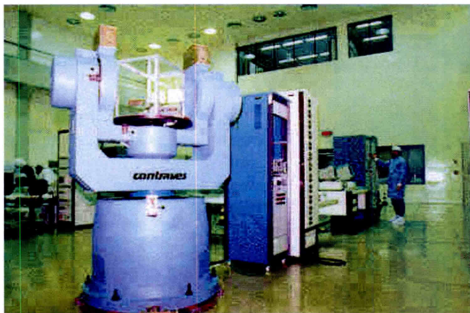
Figura 2.1 – Simulador de Três eixos. Fonte: INPE - DMC (1999).
